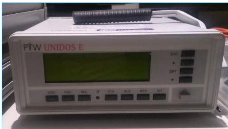
Figura 13. – Electrómetro PTW.
