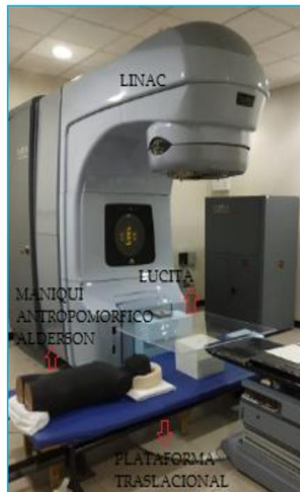
Figura 27. – Arreglo experimental para dosimetría relativa con cámara de ionización Markus Advanced.
