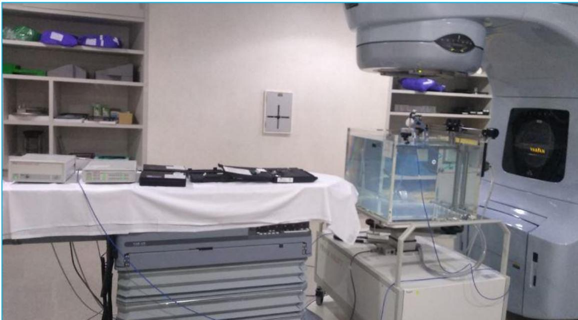
Figura 22. – Arreglo experimental para dosimetría en condiciones de referencia.
