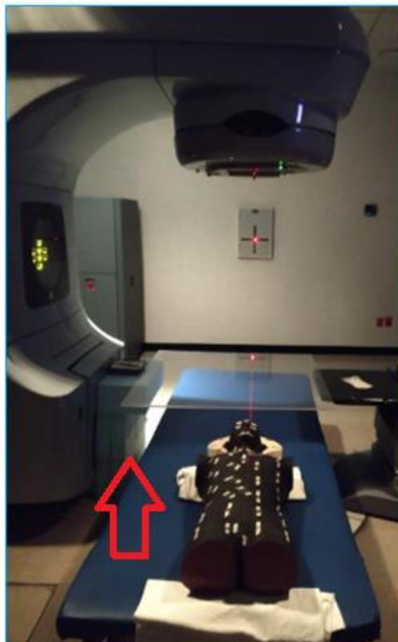
Figura 28. – Arreglo dosimétrico de películas radiocrómicas EBT2 para medir dosis a superficie del maniquí antropomórfico Alderson.
